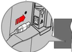
Branchez une extrémité (la fiche à deux trous) du cordon d'alimentation détachable fourni dans l'entrée du cordon d'alimentation située à l'arrière de la TV, comme indiqué ci-dessus. Branchez ensuite l'autre extrémité du cordon d'alimentation dans la prise de courant.
