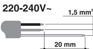
L'extrémité du fil de mise à la terre (jaune-vert) à brancher sur l'appareil devra dépasser d'au moins 20 mm.
