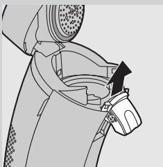
**4** Retirez l'unité d'écoulement du café de l'appareil en la faisant glisser vers le haut.
