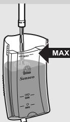
Regelmatig ontkalken verlengt de levensduur van de koffiemachine en garandeert langdurig een optimaal resultaat. Bij een gemiddeld gebruik van 2 keer per dag, dient u de machine eens in de 3 maanden te ontkalken.
