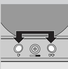
**10** Drücken Sie gleichzeitig kurz die 1-Tasse-Taste
