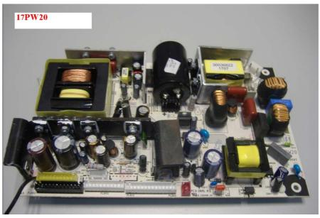
1. Nella sostituzione del modulo d' alimentazione 17PW15-9 con il modulo 17PW20 non viene effettuata nessuna modifica in quanto i due moduli sono perf patibili .
