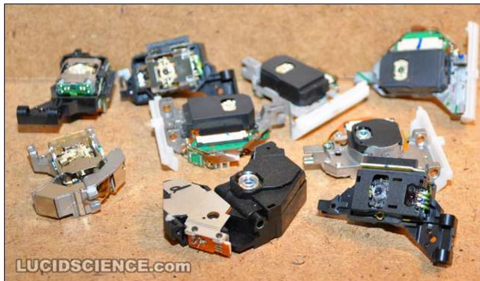
*Quelques modèles de blocs optiques...*
