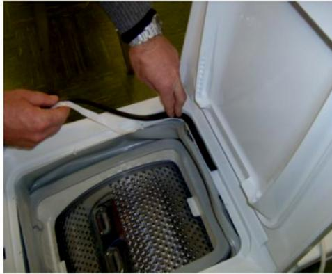
A partir du numéro de série 41119.0001, sur les modèles concernés par la présente notification a été introduite l'ouverture de chargement code pièce détachée 112743, qui n'est pas interchangeable avec la pièce avant modification 083895.
