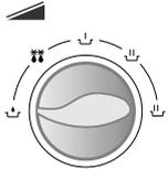
Wählen Sie eine der 5 Leistungsstufen mit dem Wählschalter.
