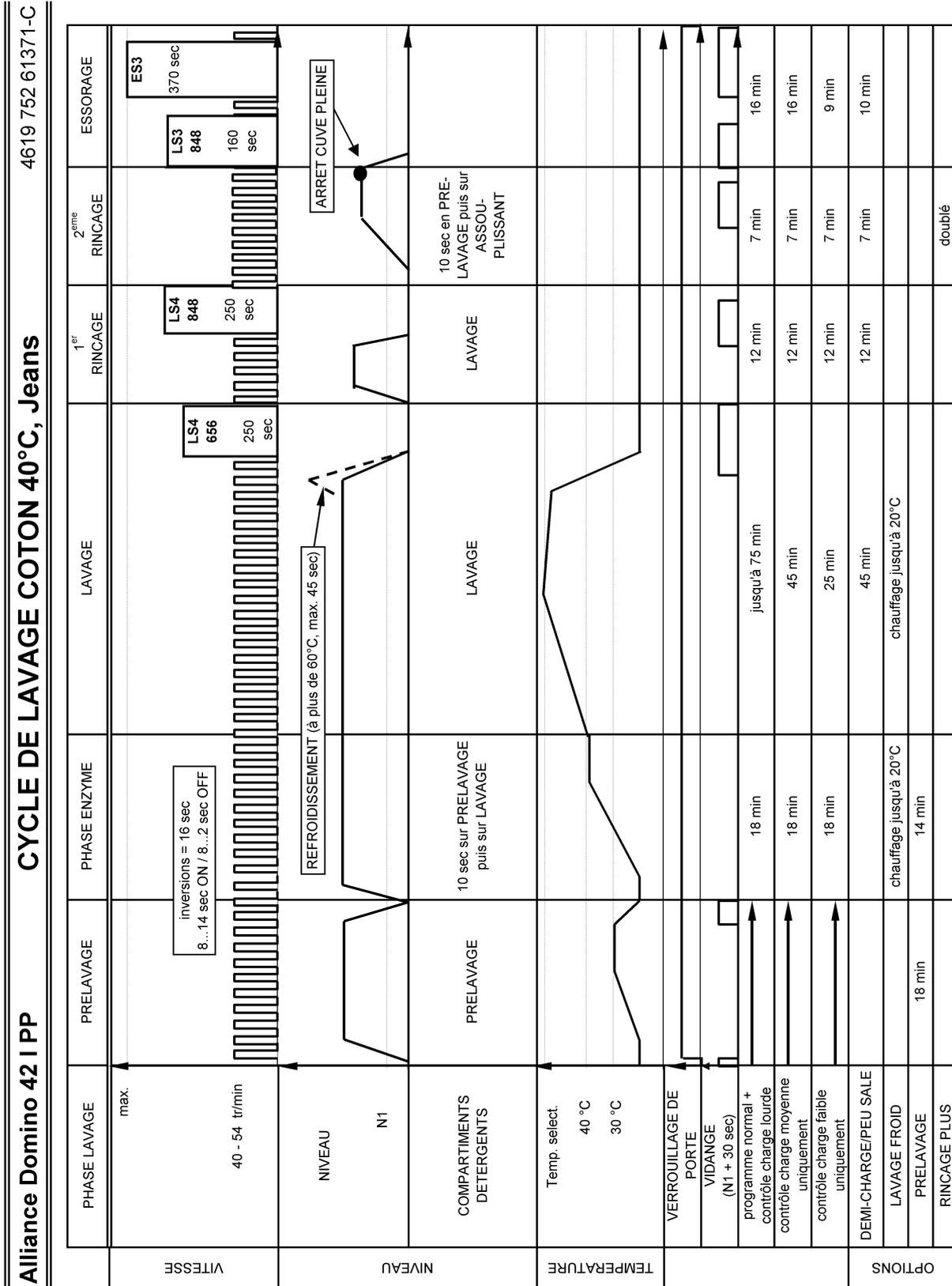
Suppression d'essorage: Les pré-essorage se font jusqu'au rinçage 3 (sans phase d'essorage). Pas d'essorage final
