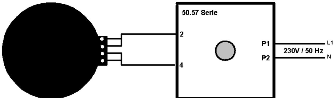
Bei Kochplatten mit 7-Takt Steuerung müssen die Kontakte 1 & 2 sowie 3 & 4 an der Kochplatte gebrückt werden.
