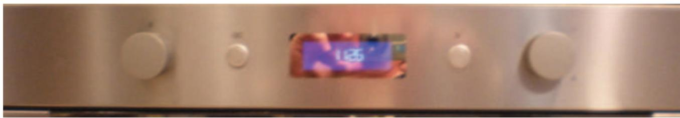
Les fours avec N° de série jusqu'à **140931xxxxxx** n'ont pas la possibilité d'être reprogrammés ; pour accéder à la configuration il est nécessaire de changer la platine de puissance et d'affichage. Pour les fours dont le N° est supérieur ou égal à **140932xxxxxx** on peut accéder au menu de configuration.
