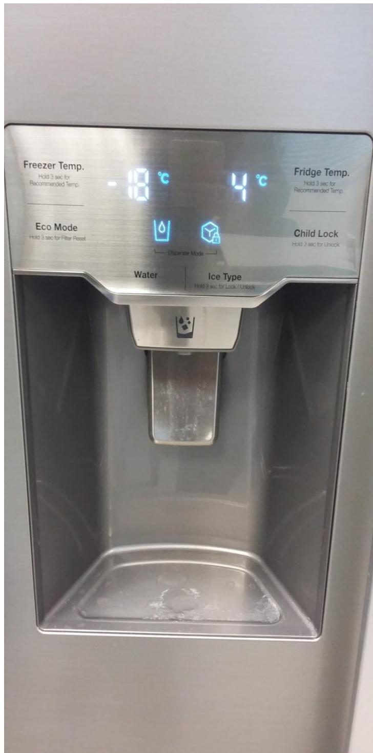
Dans cette configuration, le consommateur a verrouillé la fabrique à glaçon, c'est-à-dire qu'aucun glaçon ne sera fabriqué. Le verrouillage est activé lorsque le consommateur appuie 3 sec sur la touche "Ice type". La distribution de l'eau fraîche uniquement est active, lorsqu'il presse sur le levier de distribution. La commande n'est pas verrouillée, il pourra changer ses températures partie réfrigérateur et congélateur.
