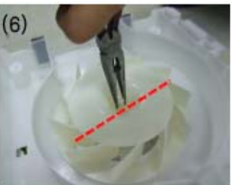
Remove the Fan Blade.
